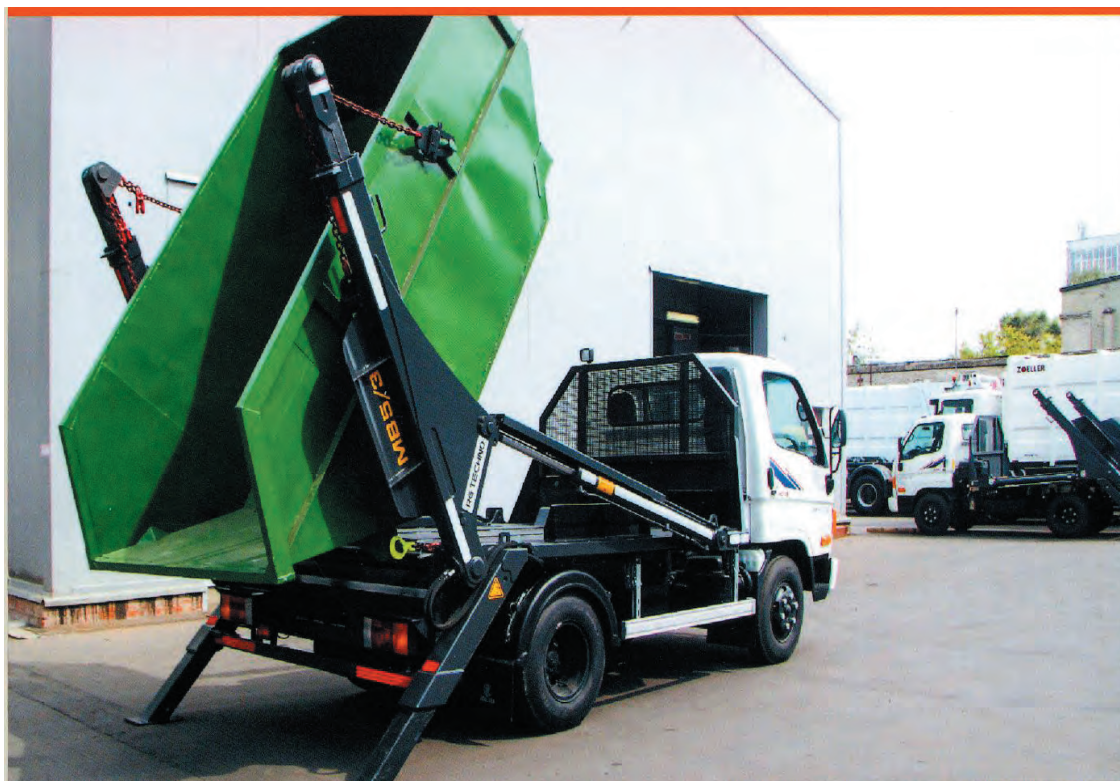
Рис. 2.11. Малотоннажный мусоровоз для перевозки в бункер-накопителях 8,0 м 3 пакетов с чистыми отходами (вторсырьё).
