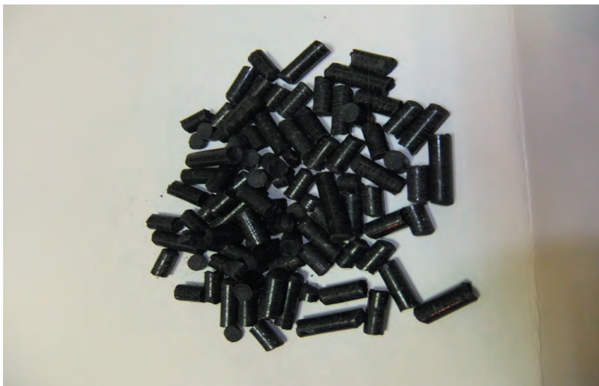
Рис. 4.1. Древесно-угольные пеллеты диаметром 6,0 мм, полученные на экспериментальной пиролизной установке.
