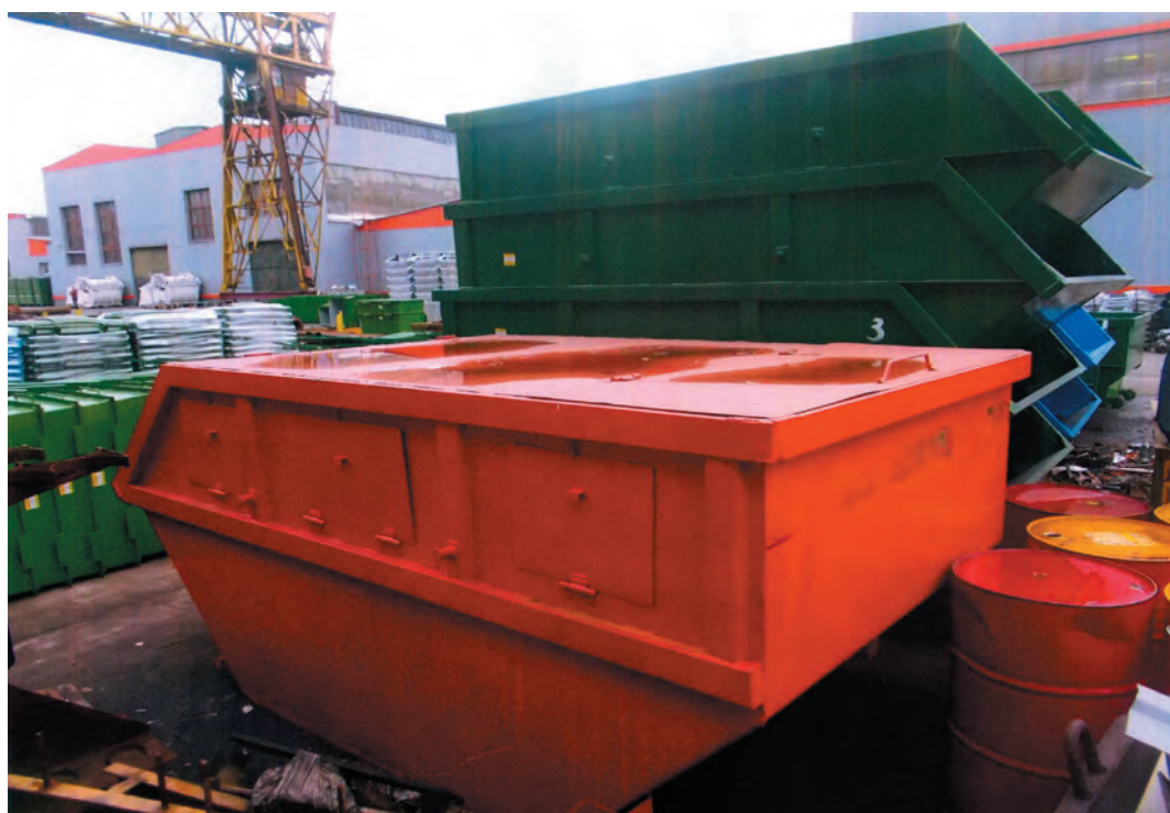
Рис 2.6. Бункер-накопитель 8,0 м 3 для сбора и вывоза вторсырья, разработанный НТС «Наука – реформе ЖКХ».
