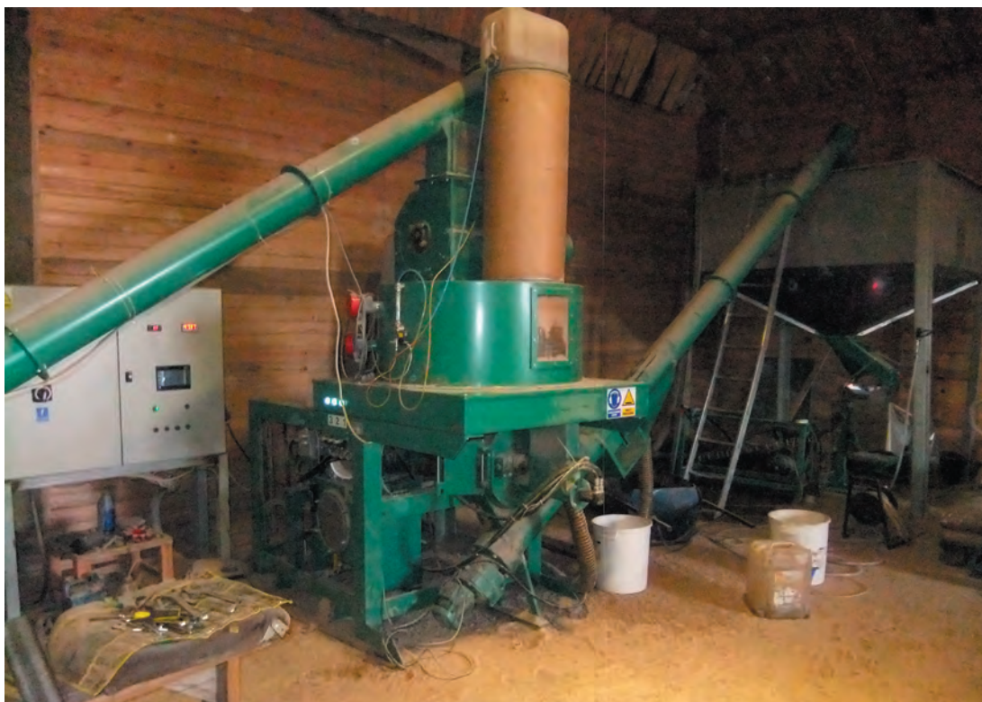
Рис. 4.2. Гранулятор «Evol-500», Польша, оборудованный для производства древесно-угольных пеллет.
